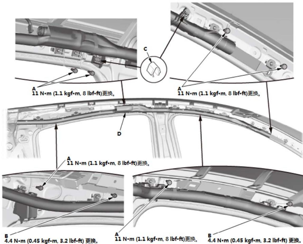
3. 拆下侧窗帘式气囊 (D)。
