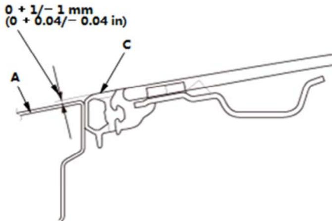
1. 车顶板 (A) 和后玻璃 (B) 应与玻璃车顶密封件 (C) 相平且保持在  $0 + 1/- 1 \text{ mm}$  ( $0 + 0.04/- 0.04 \text{ in}$ ) 以内。如果不在此范围内，则作以下调整。
