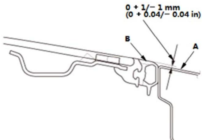
1. 车顶板 (A) 应和后玻璃车顶密封件 (B) 相平且保持在  $0 + 1/- 1 \text{ mm}$  ( $0 + 0.04/- 0.04 \text{ in}$ ) 以内。如果不在此范围内, 则作以下调整。
