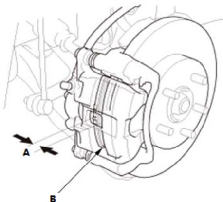
1. 检查内制动片 (B) 和外制动片 (C) 的厚度 (A)。不包括底板厚度。
