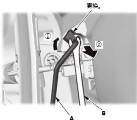
1. 用卡扣拆卸工具 (B) 断开外把手杆 (A)。
