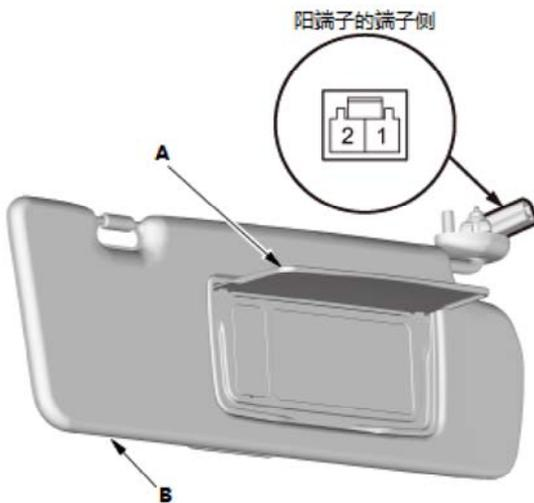
注意：进行化妆镜灯测试时，正确安装灯泡。
