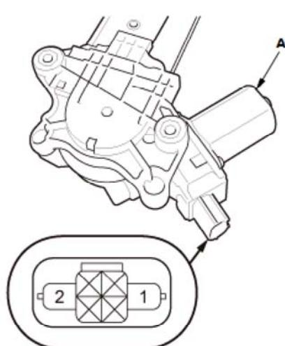
2. 根据下表，通过连接 12 V 蓄电池电源和搭铁，测试后电动车窗电机 (A)。当后电动车窗电机停止运转时，立即断开 12 V 蓄电池电源。
