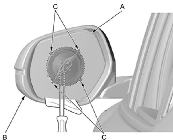
1. 小心地用手推动后视镜镜架 (A) 的上边缘。
