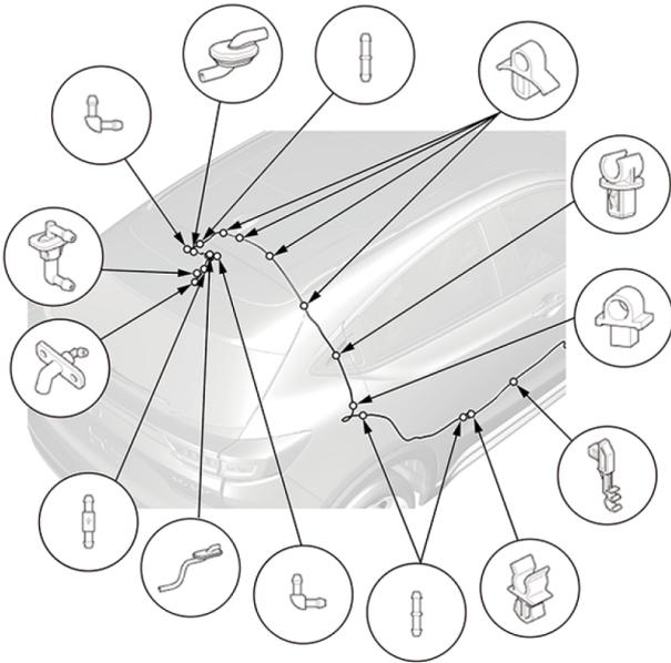
1. 拆下后清洗器管。
