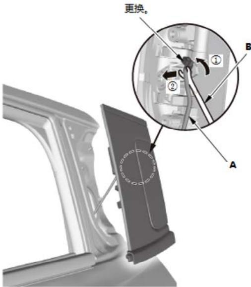
4. 将连杆紧固件 (A) 从后车门外把手 (B) 上拆下, 然后用新的予以更换。
