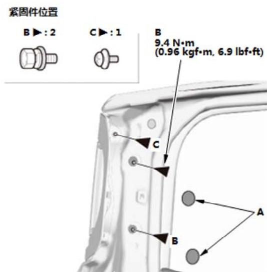
1. 拆下保养孔密封件 (A)、螺栓 (B) 和螺钉 (C)。
