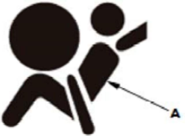
如果系统正常，将车辆转为ON模式时SRS指示灯应点亮，然后6秒钟后熄灭。若非如此，则系统有故障。
