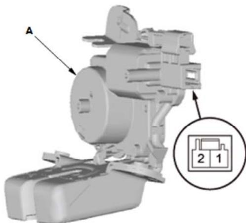
1. 根据下表，通过连接电源和搭铁，检查执行器工作情况。
