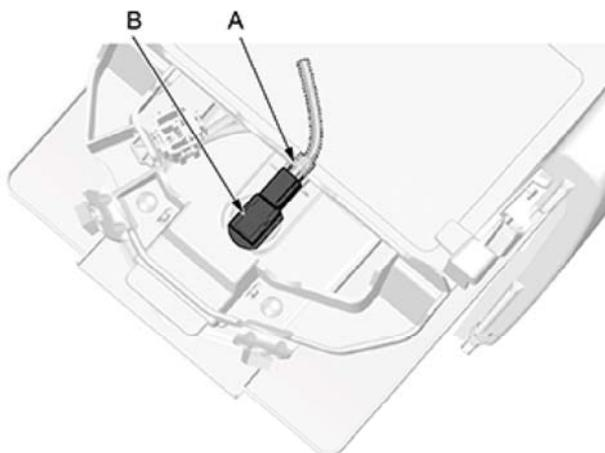
1. 脱开扶手箱灯插接器 (A)，旋转取出扶手箱灯 (B)。
