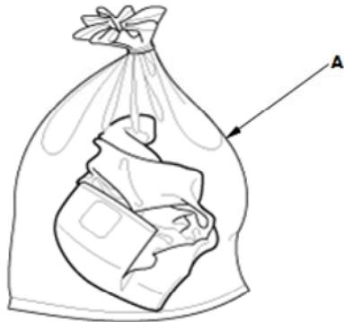
19. 报废整个气囊或张紧器。任何零件都不能重新使用。将其放到结实的塑料包 (A) 中，并牢固密封。根据当地规定，报废已展开的气囊。
