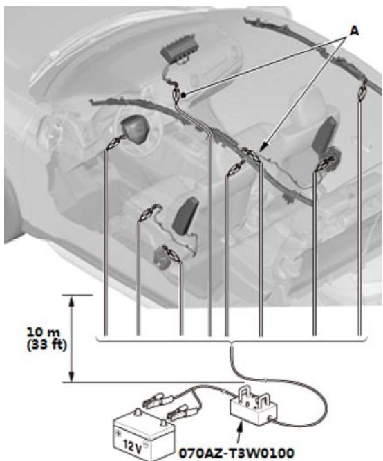
15. 切断各连接器并剥开导线末端。若要防止充气装置意外展开，扭曲各充气装置的各对导线，将各充气装置短路。
