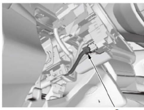
如果配有 SRS 的车辆完全报废，它的前气囊、侧气囊、侧窗帘式气囊和安全带张紧器仍然在车内时，应被展开。这些零件不能被认为是可回收的零件，切勿安装到其他车辆上。
