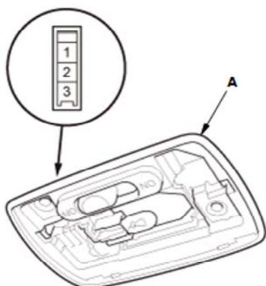
注意：执行顶灯测试时，确保正确安装灯泡。
