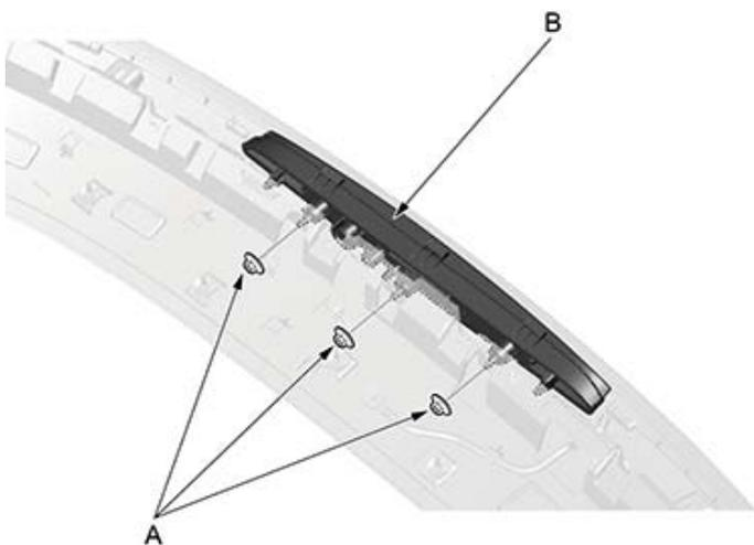
1. 使用8mm套筒拆卸高位制动灯固定螺母 (A)，向外滑动，取下高位制动灯 (B)。
