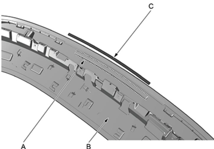
1. 如果再次安装原来的高位制动灯，在要粘贴新的双面胶带 (A) 的区域涂抹胶粘剂底胶，然后将新的双面胶带划线处 (C) 粘贴至如图所示的尾门扰流板装饰件(B)。
