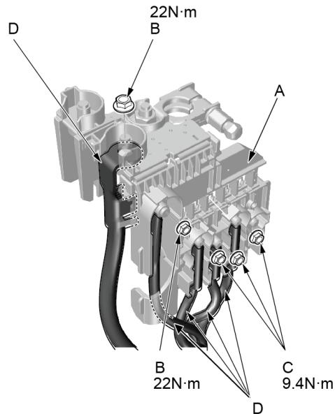
1. 使用12mm套筒拆卸线束固定螺母 (B)。
