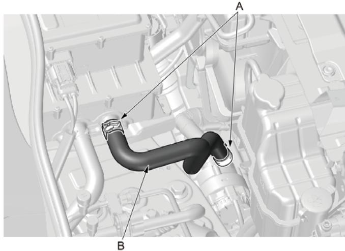
1. 使用水管卡箍拆装钳脱开三合一与电动水泵连接水管固定卡箍（A）。
