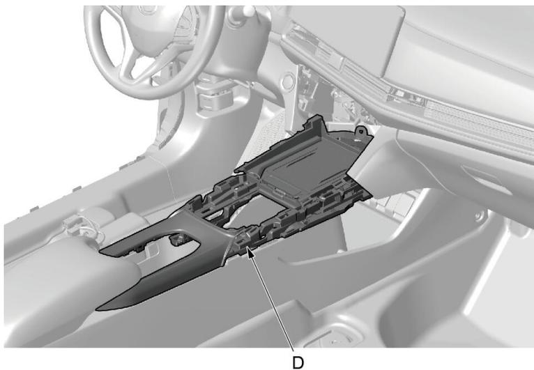
4. 使用内饰件拆卸工具撬开中央扶手箱上面板固定卡扣，取下中央扶手箱上面板（D）。
