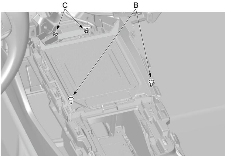
2. 使用十字起拆卸中央扶手箱上面板固定螺钉 ( B ) 。
