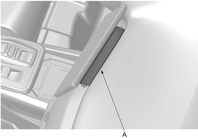
1. 使用内饰件拆卸工具拆卸中控液晶屏上方装饰件 (A)。
