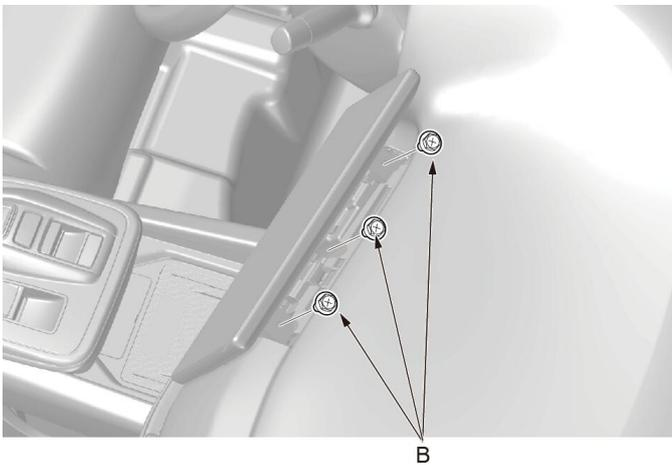
2. 使用8mm长套筒拆卸中控液晶屏3个固定螺栓 (B)。
