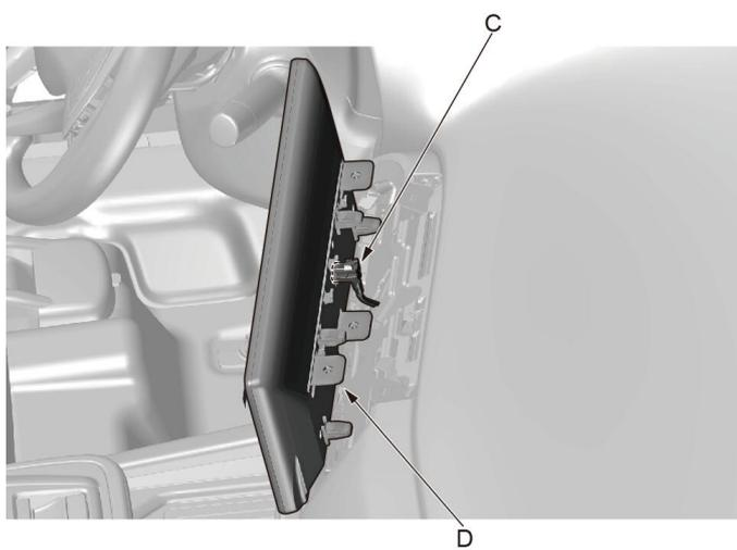
3. 使用内饰件拆卸工具撬开中控液晶屏 (D)。
