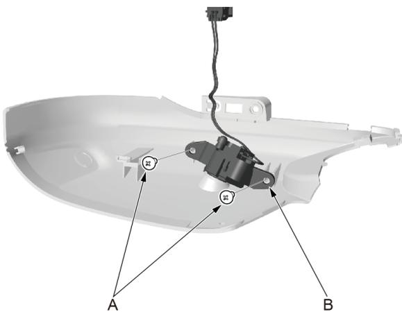
1. 使用十字起拆卸两颗侧投影灯固定螺钉 (A)。
