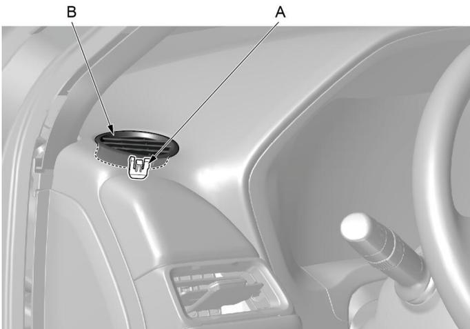
1.使用内饰件拆卸工具撬开侧除雾器通风装饰件固定卡（A），取下侧除雾器通风装饰件（B）。
