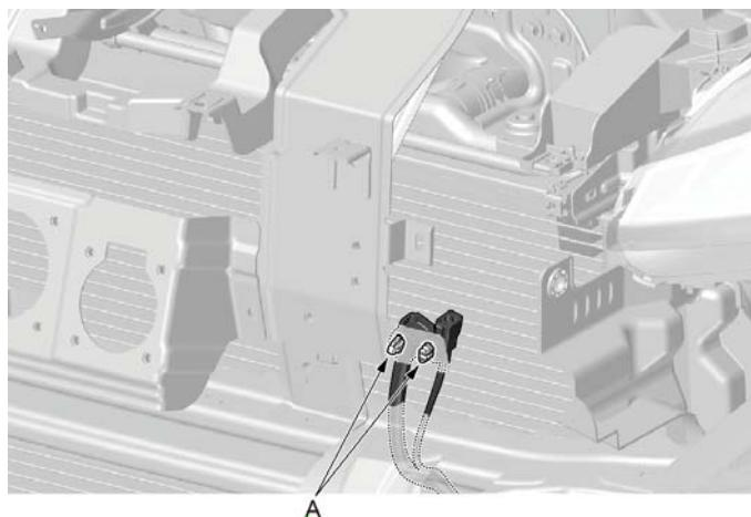
1.使用内饰件拆卸工具脱开线束固定卡扣(A)。
