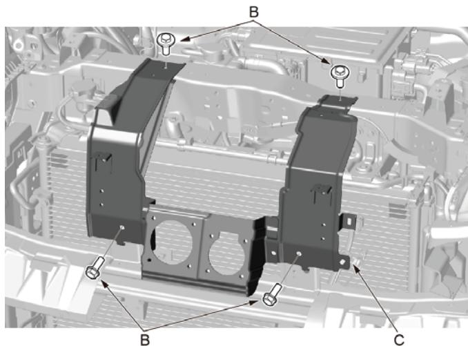
2.使用10mm套筒拆卸充电口支架固定螺栓(B)。
