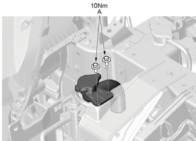
1.使用10mm套筒拆卸固定螺栓(A)，脱开散热器水管头。
