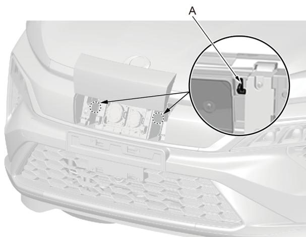
1. 检查充电口罩是否破裂、损坏。如果发现任何损坏，更换充电口罩。
