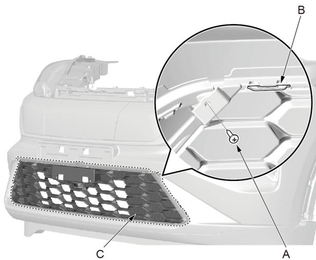
1. 使用十字起拆卸前保险杠下格栅固定螺钉（左右各一颗）（A）。
