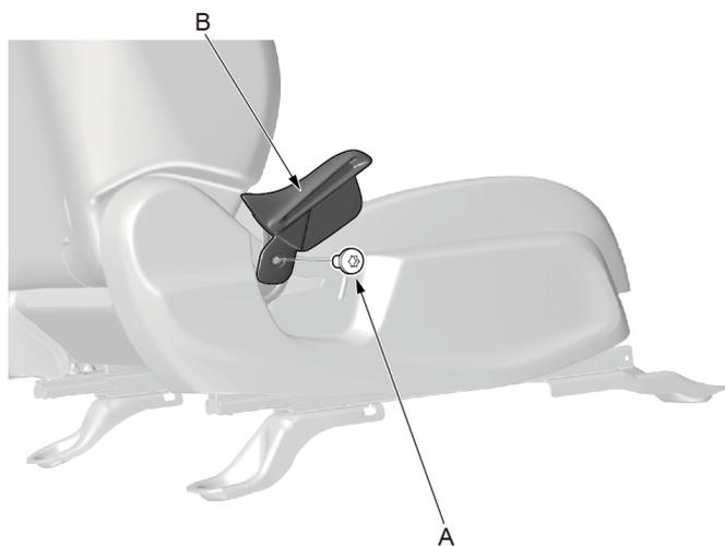
1. 使用 T25 旋具头拆卸螺钉 (A)，然后取下前排乘客座椅靠背倾角调节器把手盖 (B)。
