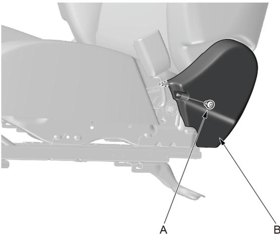
1. 使用 T25 旋具头拆卸螺钉 (A)，然后取下前排乘客座椅倾角调节器内侧盖 (B)。
