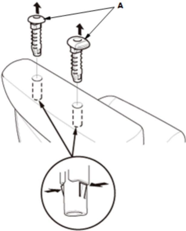
13. 拆下前排座椅靠背护面/软垫(A)。
