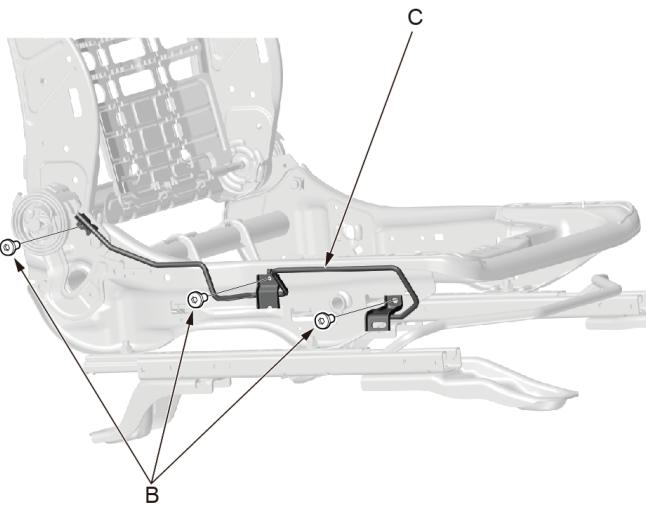
1. 使用 T25 旋具头拆卸三颗螺钉 ( B ) , 然后拆下前排驾驶员座椅外倾角调节器盖固定杆 ( C ) 。
