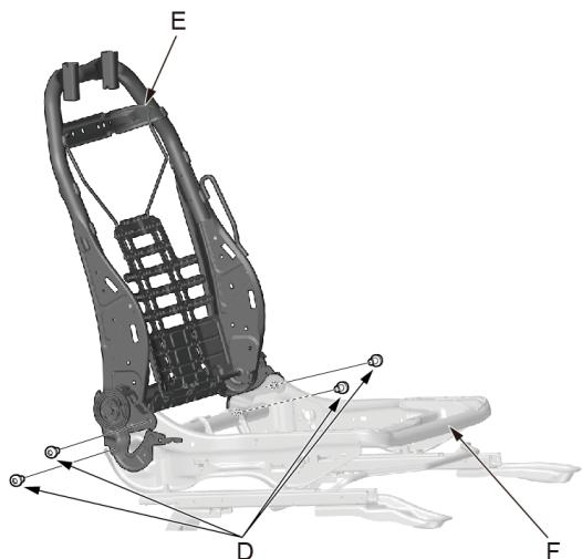
1. 用T50旋具头拆卸四颗螺栓 ( D ) , 然后从前排座椅座垫框架 ( F ) 拆下前排座椅靠背框架 ( E ) 。
