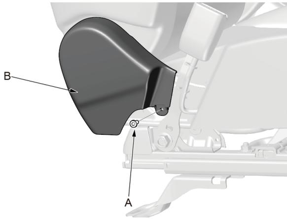
1.使用 T25 旋具头拆卸螺钉 ( A ) , 然后取下前排乘客座椅倾角调节器内侧盖 ( B ) 。
