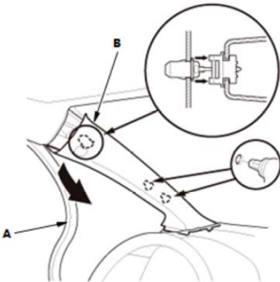
3. 在前立柱装饰件 (B) 和车身之间的开口放一块抹布 (A)，以免前立柱卡扣掉落。
