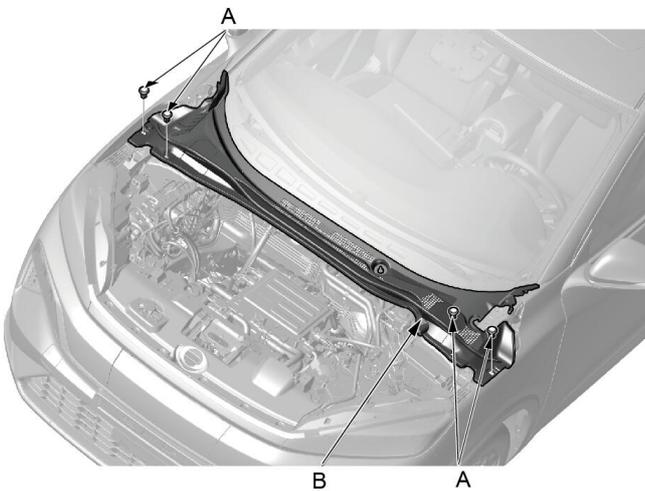
1. 使用内饰板拆卸工具拆卸前罩板固定卡夹（A），取下前罩板（B）。
