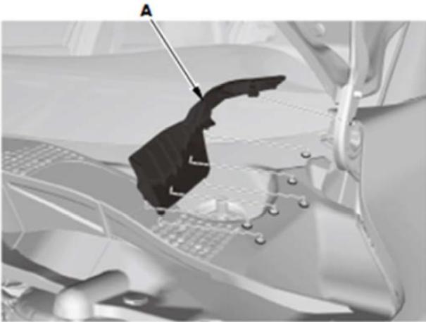
1. 拆下前翼子板罩（A）。（两侧）
