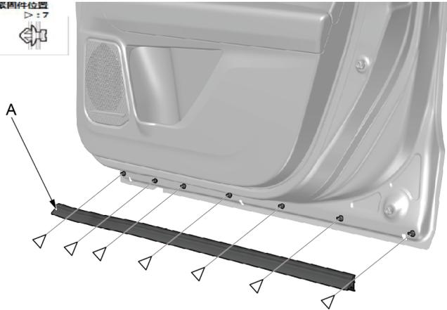
1. 使用内饰件拆卸工具拆卸固定卡扣，取下前车门下密封件（A）。
