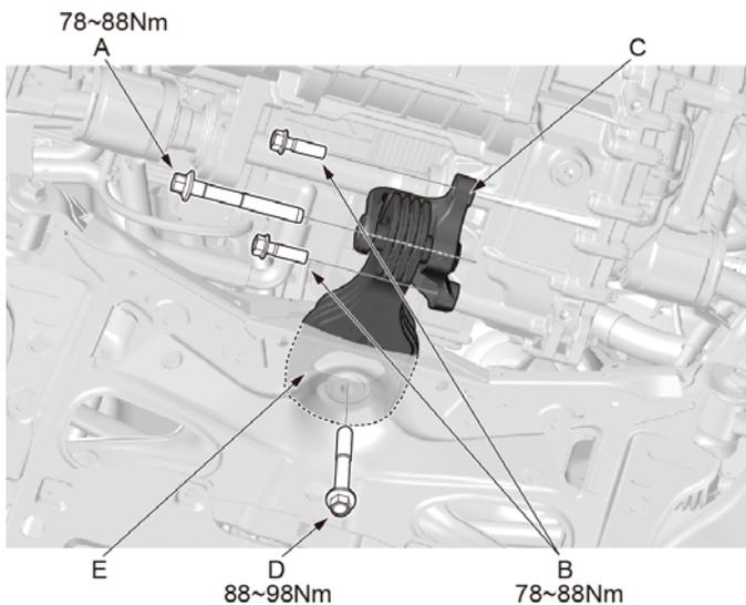
1.使用 17mm 套筒扳手拆卸动力总成弹性支架与固定支架连接螺栓 (A) (M14×112) 。
