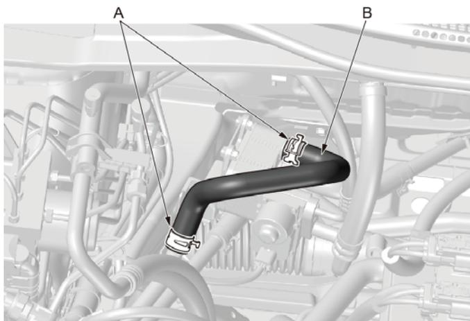
1.使用水管卡箍拆装钳脱开冷却器出水管固定卡箍(A)，左右旋转晃动，脱开并取下出水管(B)。
