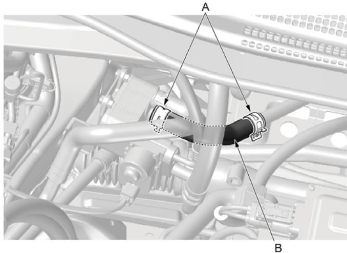
1.使用水管卡箍拆装钳脱开冷却器进水管固定卡箍(A)，左右旋转晃动，脱开并取下进水管(B)。
