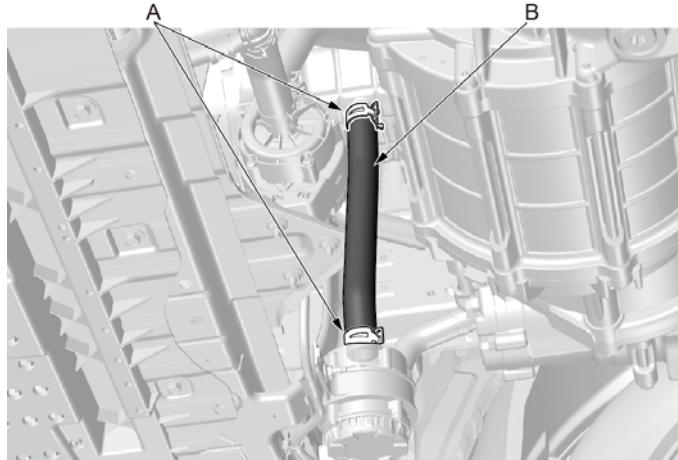
1.使用水管卡箍拆装钳脱开动力电池包冷却液膨胀水箱出水管两端固定卡箍 (A), 左右摇晃，脱开并取下膨胀水箱出水管 (B)。
