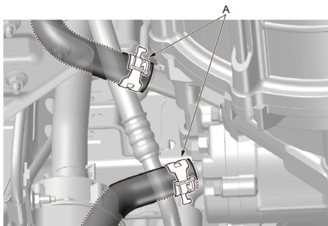
1. 使用水管卡箍拆装钳脱开金属管连接水管固定卡箍 (A)，旋转脱开与金属管的连接。
