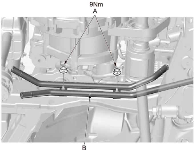
1. 使用10mm套筒或10mm扳手拆卸动力电池包冷却液金属管与车身固定螺母(A)。
