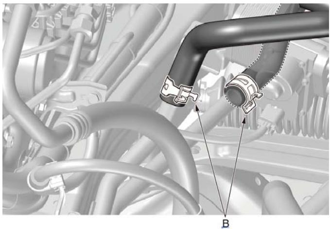
2. 使用水管卡箍拆装钳脱开金属管连接水管固定卡箍（B），旋转脱开与金属管的连接。
