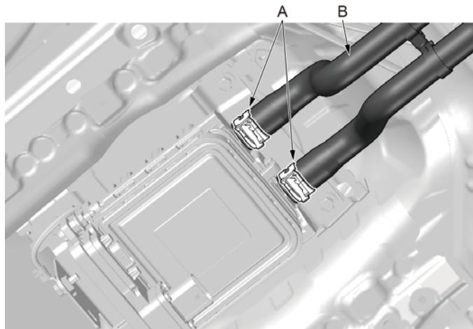
1. 使用水管卡箍拆装钳脱开动力电池包冷却系统 加热器 PTC 进、出水管固定卡箍 (A)，左右摇晃，脱开动力电池包冷却系统加热器 PTC 进、出水管 (B)。
