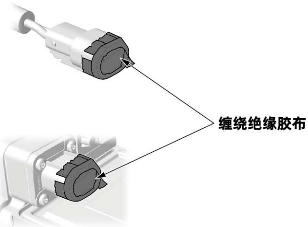
2.拆卸高压线束后，务必使用绝缘胶带分别缠绕高压接口的公插头及母插头，以防触电。
