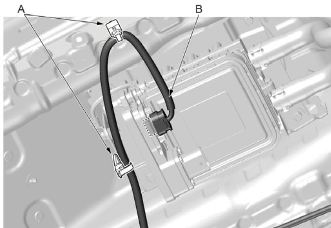
1. 使用内饰件拆卸工具撬开动力电池包加热器 PTC 信号线固定卡扣 (A)。
