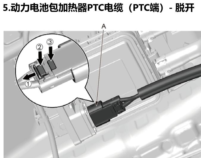
1. 向后拨开锁止卡扣①，按压锁止卡②，脱开插接器直至插接器再次锁止，再次按住插接器锁止卡③，脱开动力电池包加热器 PTC 高压电缆插接器(A)。
