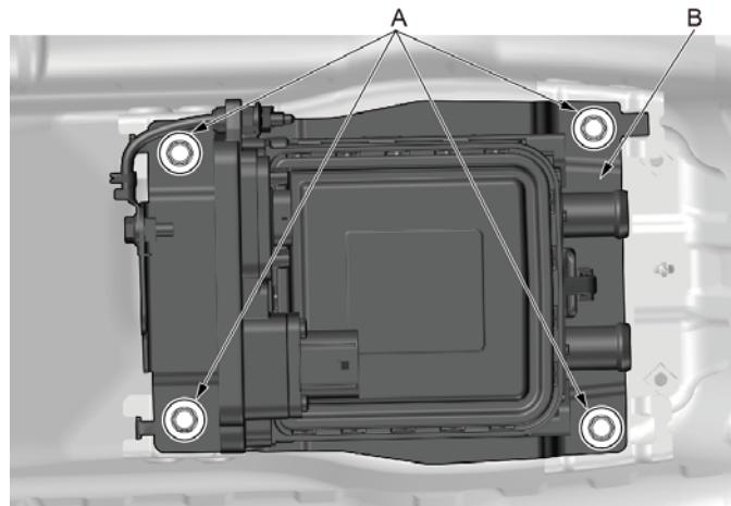
1. 使用10mm套筒拆卸动力电池包加热器PTC固定螺栓 (A) (M6×12)。
