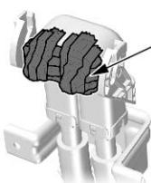
6.拆卸高压线束后，务必使用绝缘胶带分别缠绕高压接口的公插头及母插头，以防触电。
