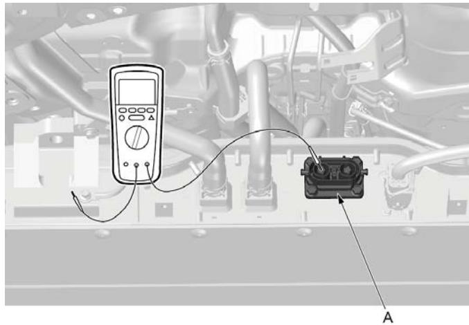
1.使用绝缘电阻检测表测量动力电池包高压电缆插头 (A) 与动力电池包壳体之间的绝缘电阻。将检测探头正极与电缆插头连接，检测探头负极与动力电池包壳体（非绝缘涂层）连接，观察测量值是否大于 $20M\Omega$ 。
