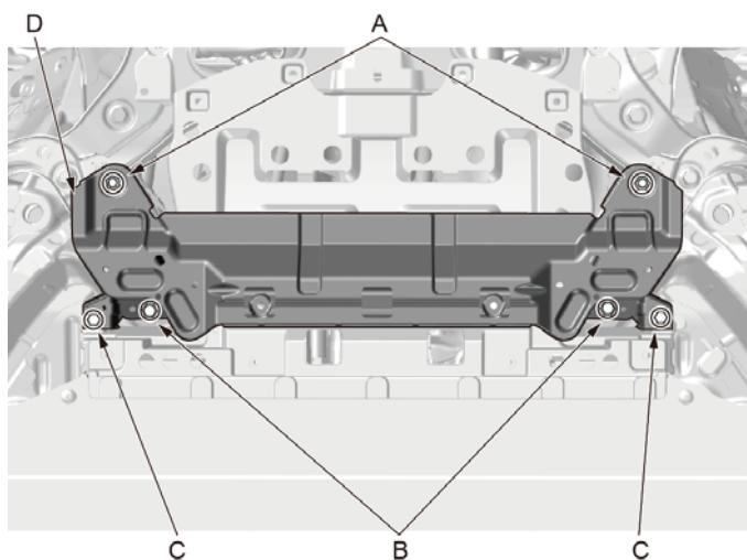
1. 使用17mm套筒扳手拆卸动力电池包防撞梁的2个固定螺母(A)。
