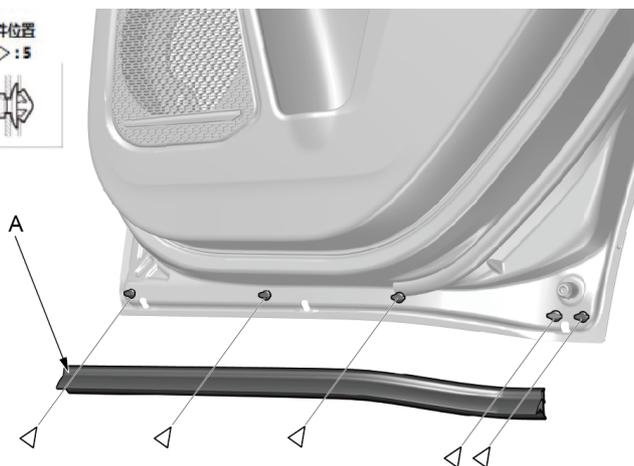
1. 使用内饰拆卸工具拆卸固定卡扣，取下后车门下密封件（A）。
