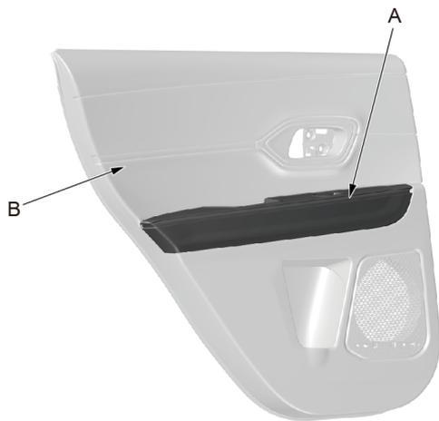
2. 将后车门扶手 (A) 从后车门板 (B) 上拆下。
