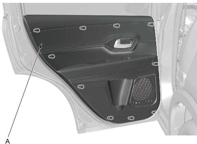
5. 使用装饰件工具, 从后车门板 (A) 的底部开始, 拆下卡扣。
