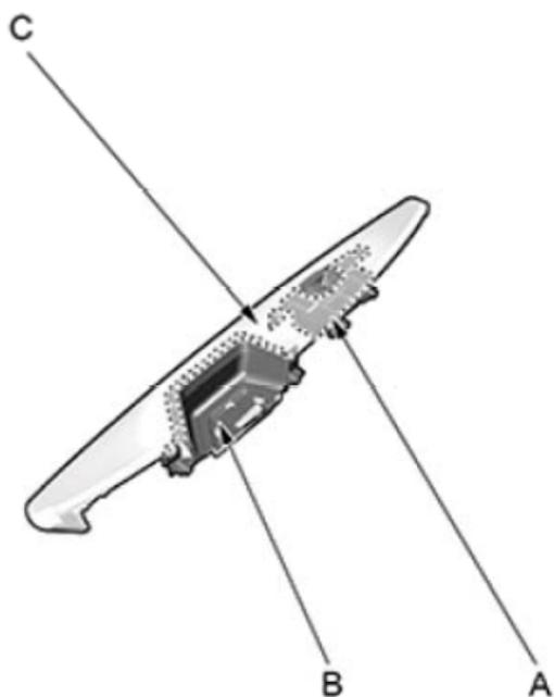
1. 从后车门扶手 (C) 上拆下电动车窗开关板 (A) 和储物盒 (B)。
