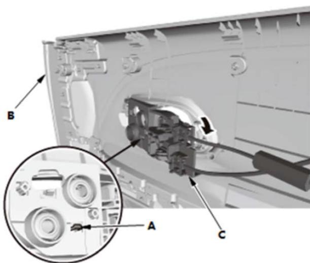
6. 固定后车门板 (B) 时松开钩 (A), 拆下后车门内把手 (C)。
