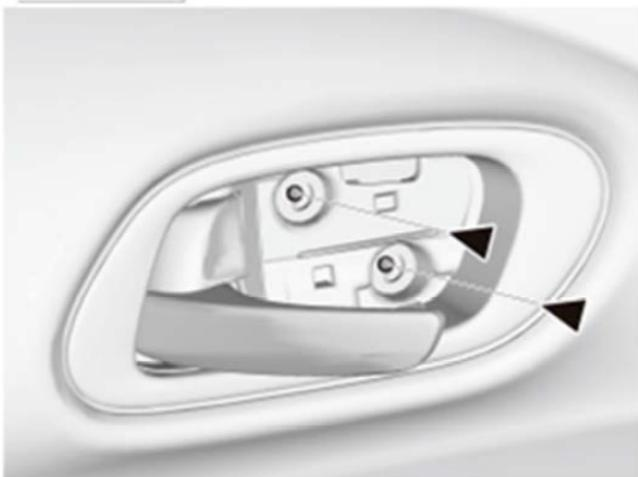
2. 使用十字起拆卸后车门板固定螺钉（A）。
