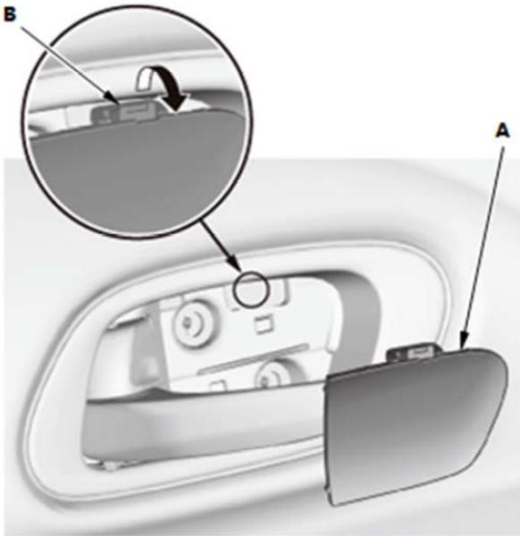
1. 使用一字起，向下倾斜钩（B）拆下盖（A）。
