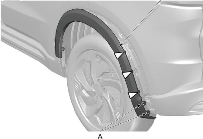
2. 从后轮拱板防护条 (B) 的后侧松开钩 (A) 和卡扣。
