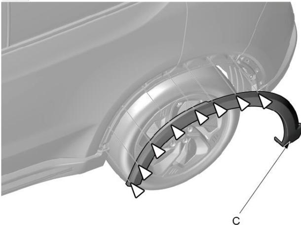
3. 拆下后轮拱板防护条 (C)。
