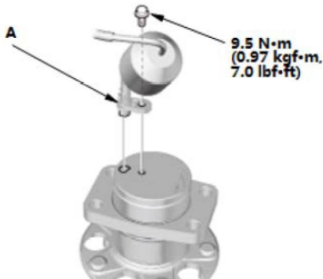
2. 拆下车轮转速传感器 (A)。
