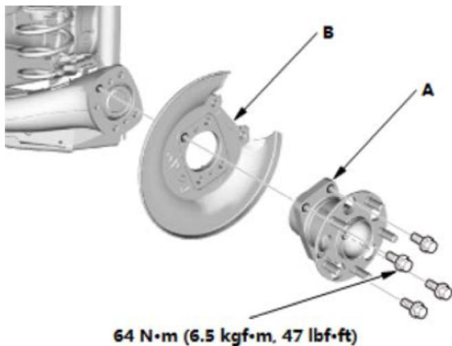
1. 拆下轮毂轴承单元 (A) 和挡泥板/后轮毂托架 (B)。
