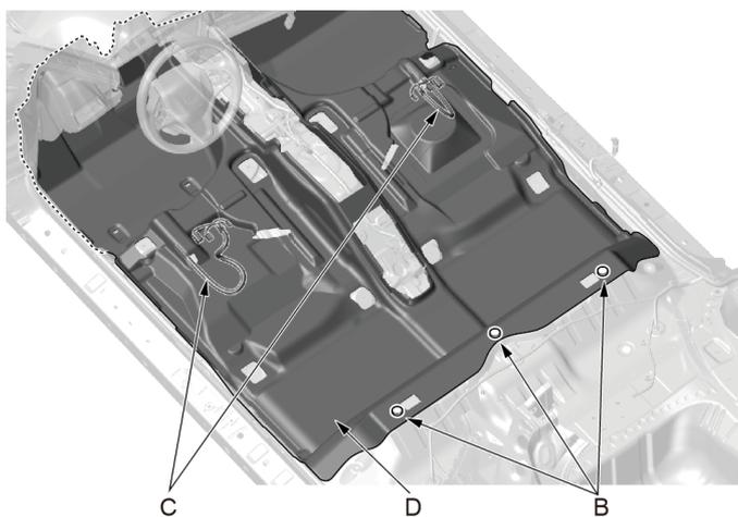
2. 使用内饰拆卸工具拆下卡扣 (B)。
