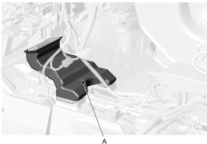
1. 拆下加热器接头管 (A)。
