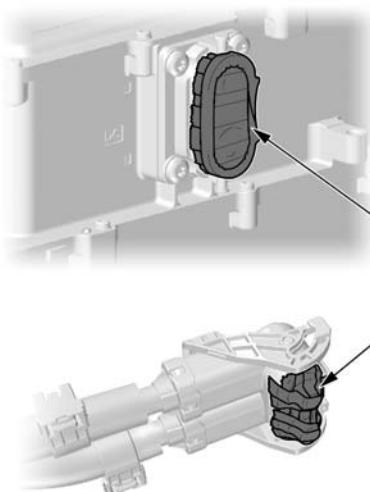
8.拆卸高压线束后，务必使用绝缘胶带分别缠绕高压接口的公插头及母插头，以防触电。
