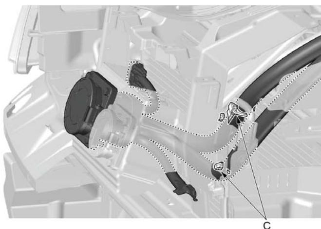
3. 使用内饰件拆卸工具拆卸快充电缆固定卡扣(C)。
