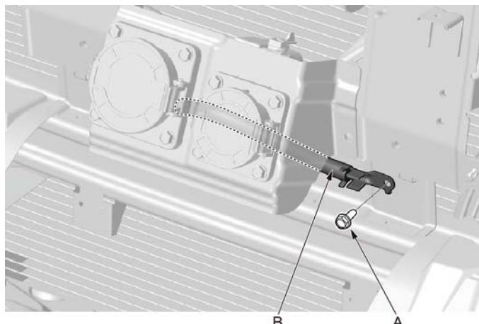
1. 使用 10mm套筒拆卸快充充电头搭铁线束固定螺栓 (A) (M6×14)，脱开搭铁线束 (B)。
