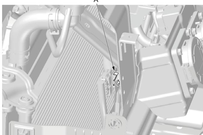
1. 使用内饰件拆卸工具拆卸快充电缆固定卡扣(A)。
