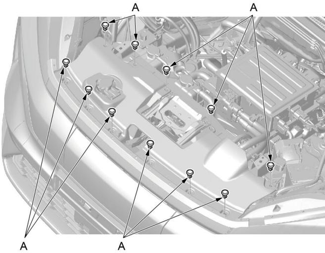
1. 使用内饰件拆卸工具拆卸散热器盖板固定卡扣 (A)。
