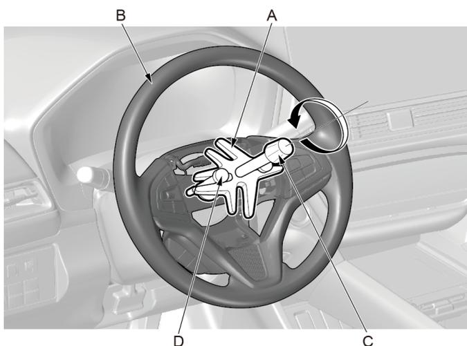
4. 在方向盘 (B) 上安装市售方向盘拔出器 (B)。
