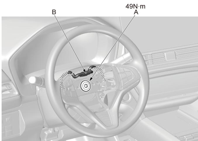
7. 安装新的方向盘螺栓 ( A ) 并将其拧至规定扭矩。
