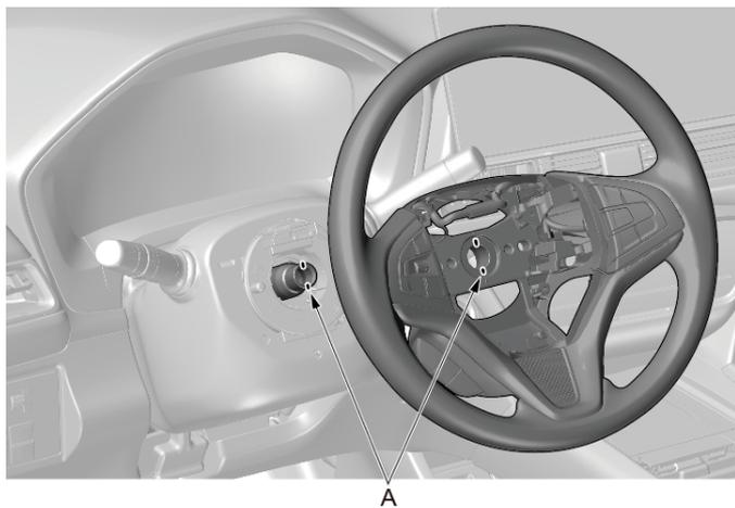
5. 将方向盘对准转向柱轴上的标记线 ( A ) 进行安装。
