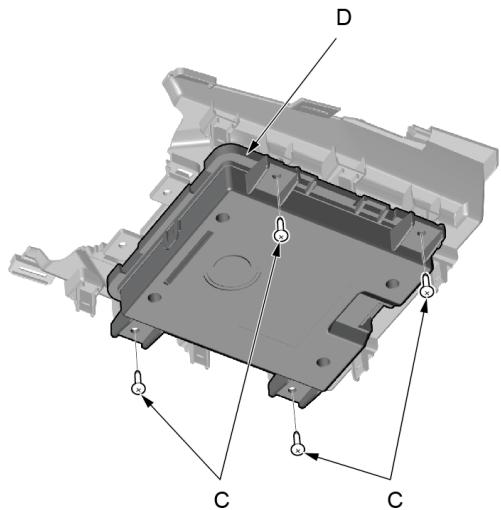
2. 使用十字起拆卸无线充电器单元总成固定螺钉 (C)，取出无线充电器单元总成 (D)。
