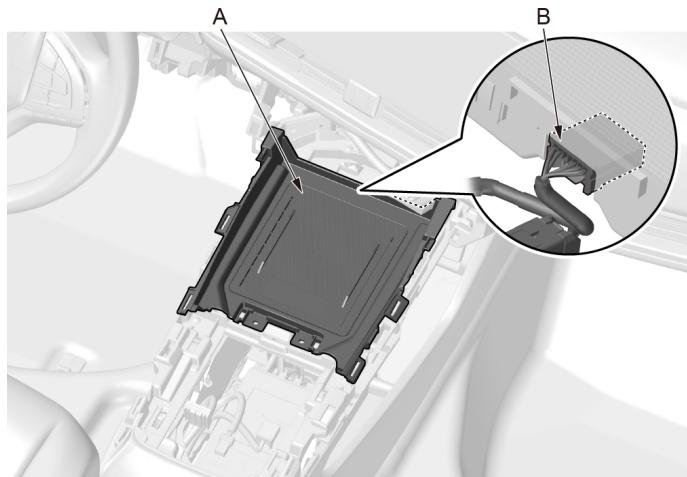
1. 使用内饰件拆卸工具拆卸下无线充电器单元总成 (A)。
