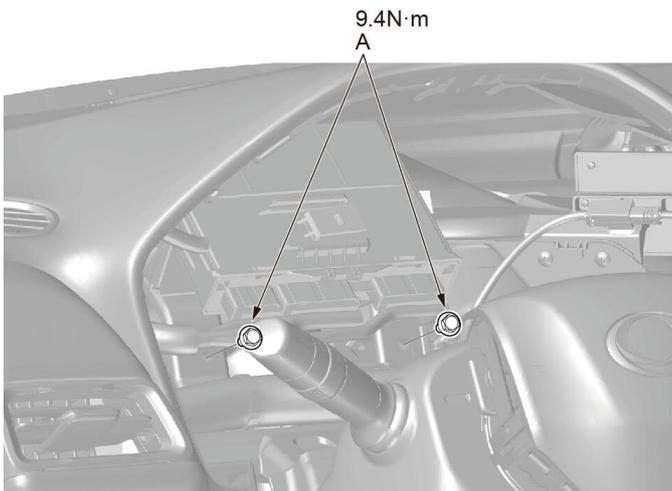
1. 使用10mm长套筒拆卸固定螺栓（A）。
